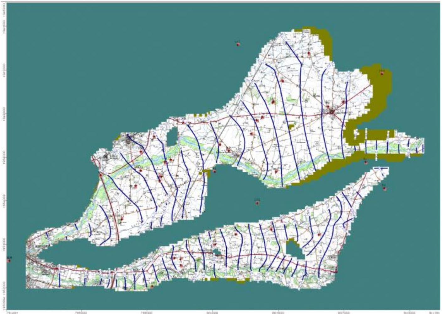
**Figure N° 28. PIEZOMETRIE INFLUENCEE EN ETIAGE SEVERE (ASSEC LOCAL DU ROUBION) (LES CELLULES MARRON-VERT REPRESENTENT UN ASSECHEMENT DE LA NAPPE).**
