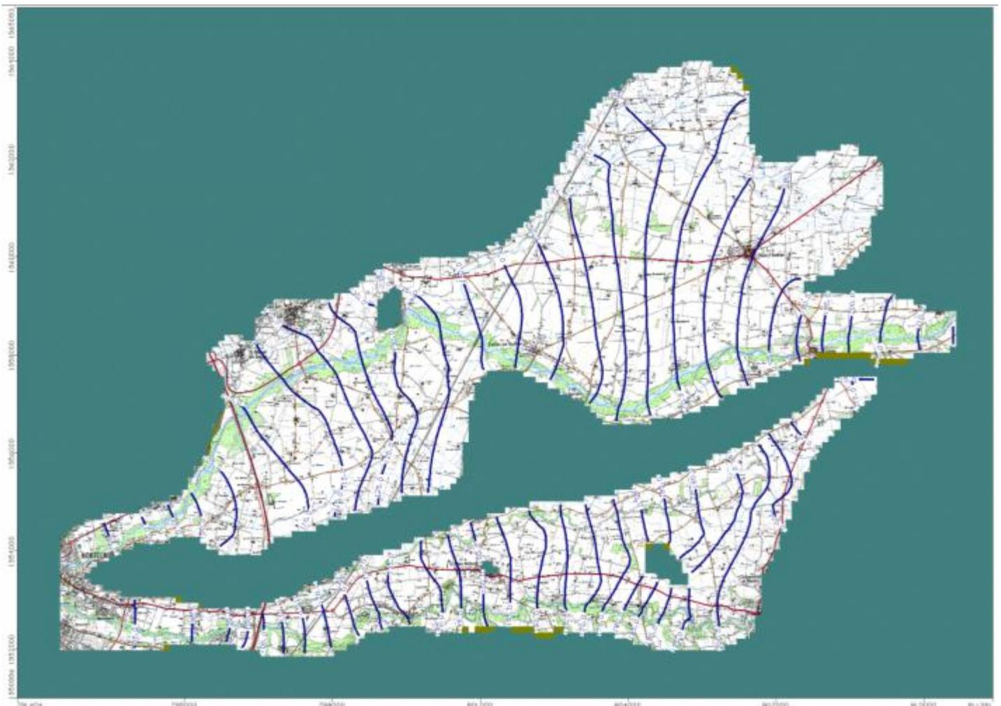
**Figure N° 25. PIEZOMETRIE NON INFLUENCEE ISSUE DE LA MODELISATION. (LES LIGNES BLEUES REPRESENTENT LES ISOPIEZES ET LES CELLULES MARRON-VERT REPRESENTENT UN ASSECHÈMENT DE LA NAPPE)**
