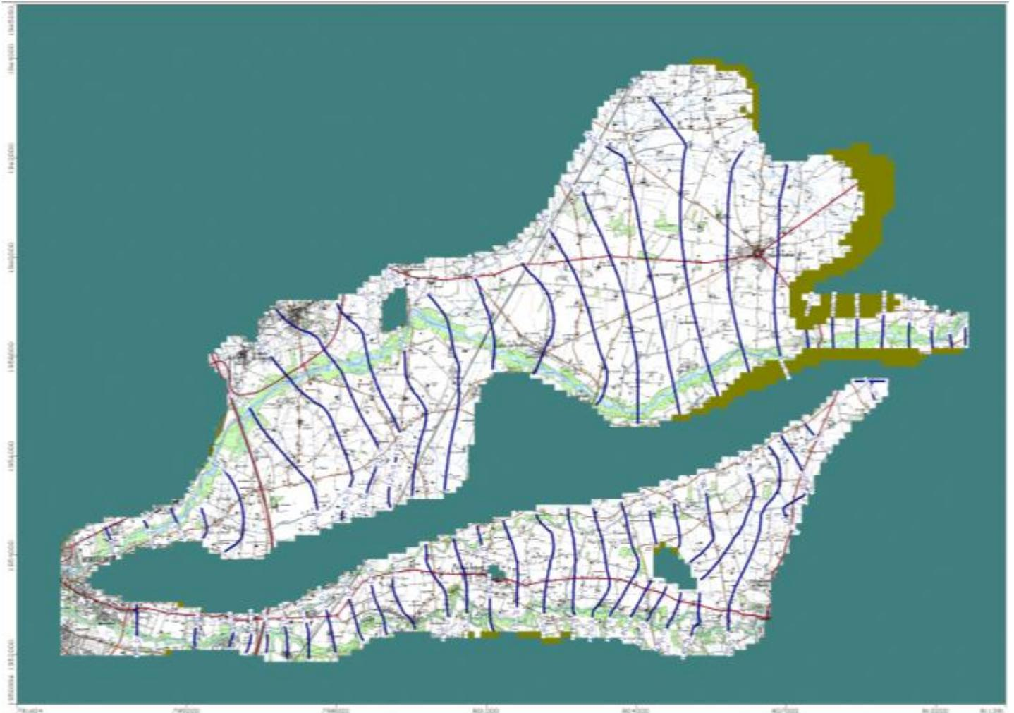
**Figure N° 27. PIEZOMETRIE NON INFLUENCEE EN ETIAGE SEVERE (ASSEC LOCAL DU ROUBION). (LES CELLULES MARRON-VERT REPRESENTENT UN ASSECHEMENT DE LA NAPPE)**
