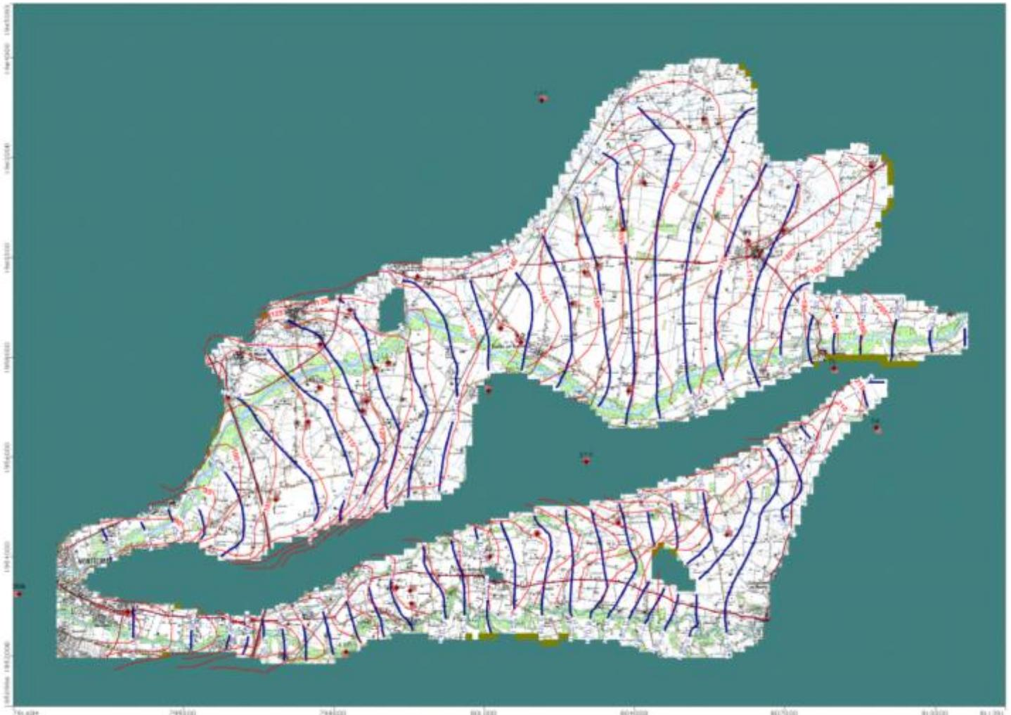
**Figure N° 21. CALAGE DU MODELE : ISOPIEZES SIMULEES PAR LE MODELE EN BLEU ET ISOPIEZES DE 1968 EN ROUGE (LES CELLULES MARRON-VERT REPRESENTENT UN ASSECHEMENT DE LA NAPPE)**
