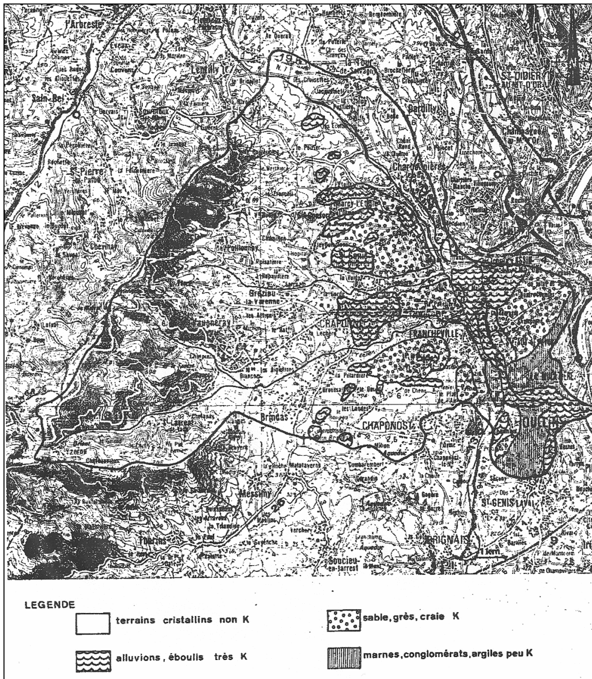
Figure 5 : Classification des matériaux de couverture (d'après GRAIE, 1986)
