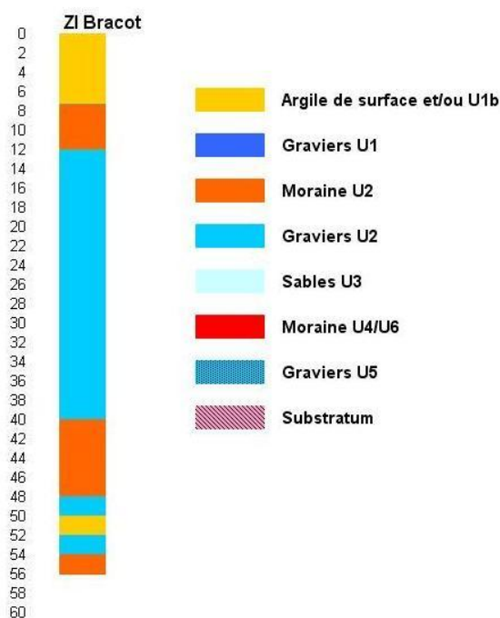
Figure 72 : Coupe simplifiée du forage ZI Bracot
