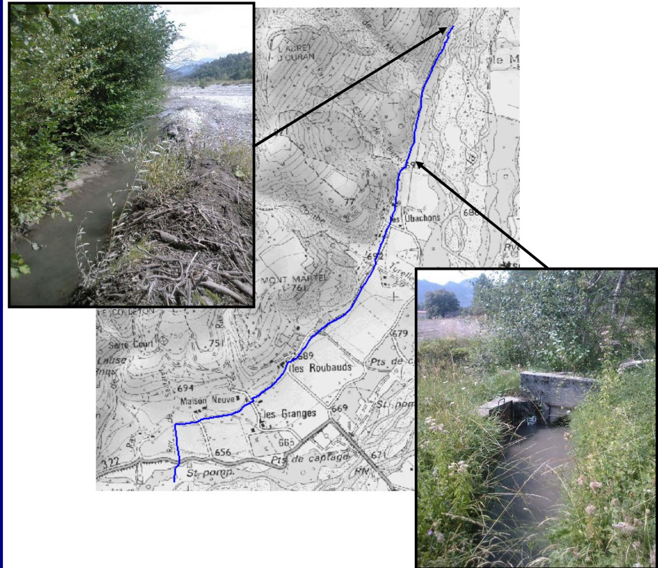
**Section type** : en amont 0.9 m de large pour 0.3 m de haut / à l'aval 0.5 m de large pour 0.3 de hau
