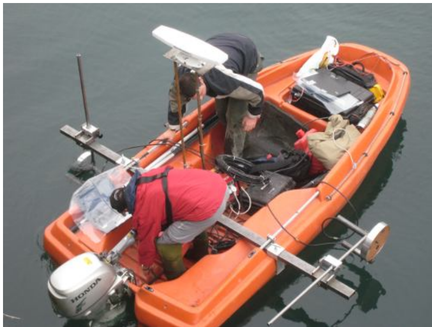
Figure 74 : Schéma de montage du matériel sur le bateau. La coupole en aluminium renforcé permet de limiter l'écoute de l'hydrophone omni-directionnel (330°) à un angle de 180°.
