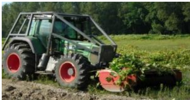
Figure 10 : Exemples d'engin utilisé pour l'essartage (tracteur forestier avec broyeur à l'avant)
