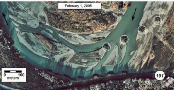
- exemple d'effet sur la diversification des axes d'écoulement et des formes alluviales
