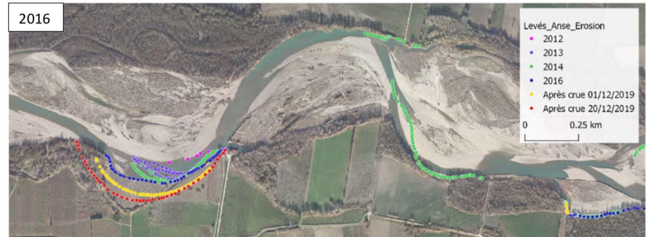
Figure 80 : Exemple d'accentuation des sinuosités sous l'effet du déficit sédimentaire (SMAVD, 2021)
