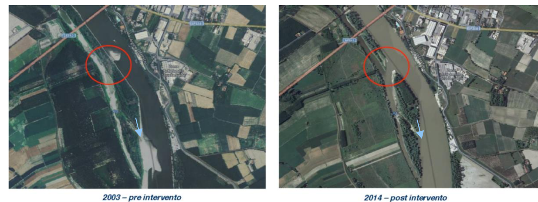
Figure 113 : Exemple de réalisation à Casalmaggiore : suppression d'épi et restauration d'un bras secondaire (AIPO, 2011 ; in Bussetini, 2019)
