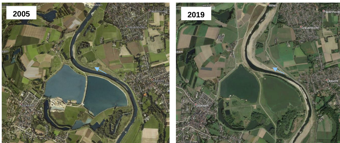
Figure 27 : Evolution du lit de la Meuse à hauteur de Grevenbicht (Grensmaas, PK45) lors des travaux de chenalisation (1850-1897) et après les travaux Maaswerken (2005-2019) (d'après Van Looy, 2012 et Google Earth)
