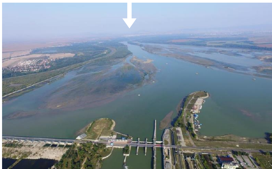
Figure 53 : Sédimentation dans la retenue et le canal de dérivation de l'aménagement de Gabčíkovo (Google Earth, 2021 / haut ; Sebestova, 2018 / bas)
