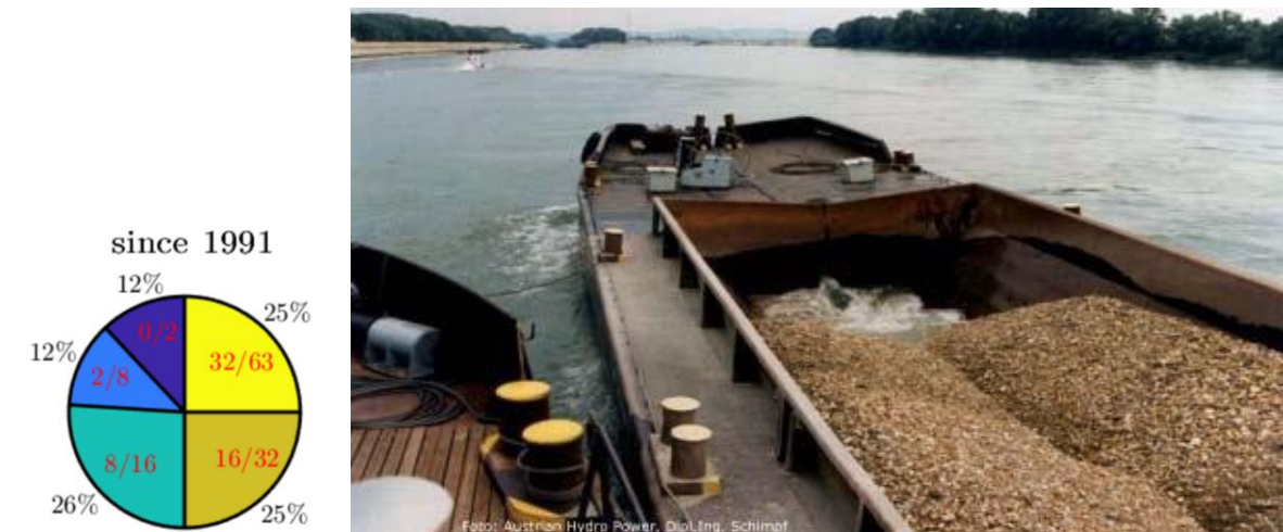
Figure 19 : Mélange granulométrique fourni en aval d'Iffezheim depuis 1991. Illustration d'une barge à clapet (Source : Emmanouil, 2017, et Arnaud, 2012)
