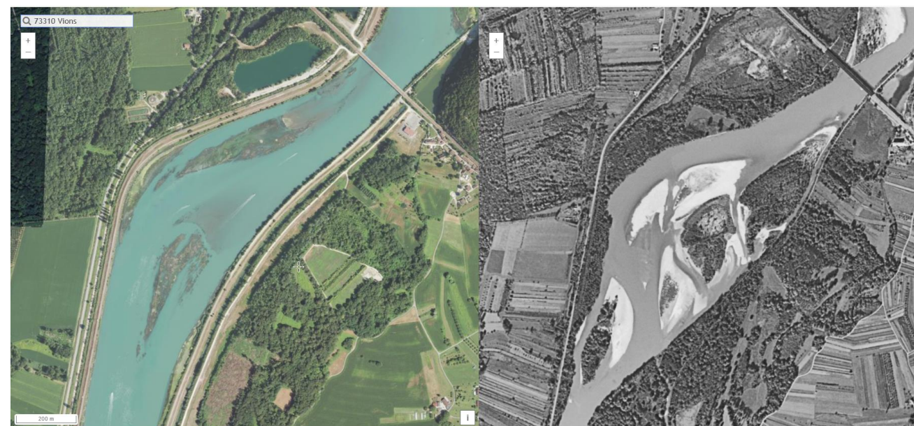
Figure 31 : Endiguement large autour de la bande active dans la retenue de Belley favorisant l'émergence de hauts fonds (remonterletemps.ign.fr)
