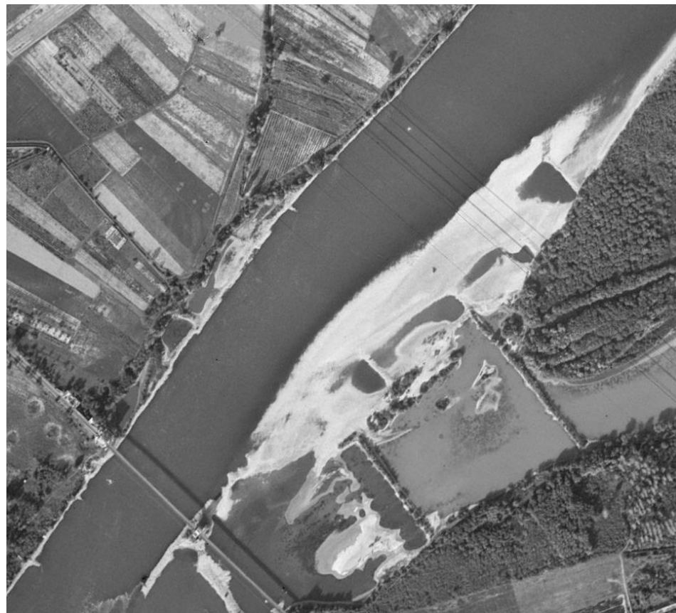
Figure 33 : Charge de fond retenue dans des épis Girardon avant les premiers aménagements hydroélectriques (en haut : en amont de la confluence avec le Lavézon ; en bas : au droit de l'ancien pont de Rochemaure / 18-MON) (IGN, 1949)
