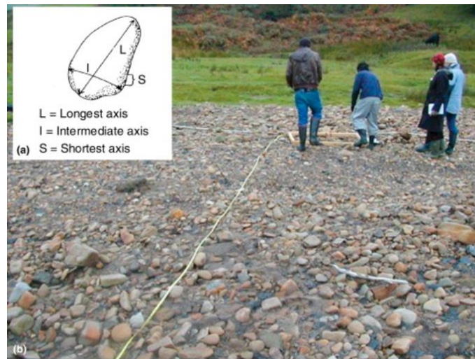
Figure 54 : mesures « Wolman » le long d'un décimètre
