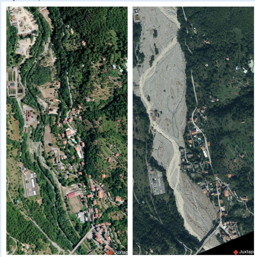
Figure 22 : Élargissement brutal de la bande active et fort engravement de la Vésubie suite à la tempête Alex d'octobre 2020 près de Roquebillière (période de retour des précipitations sur 24 h de plusieurs milliers d'années...)
