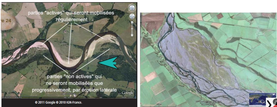
Figure 32 : Exemples de stockage naturel des alluvions grossières en transit (parties végétalisées des bancs).
