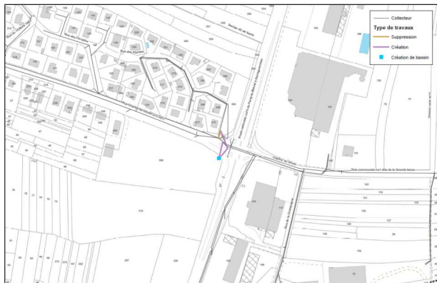
Bassin de stockage/restitution en aval du DO10 à Brochon
