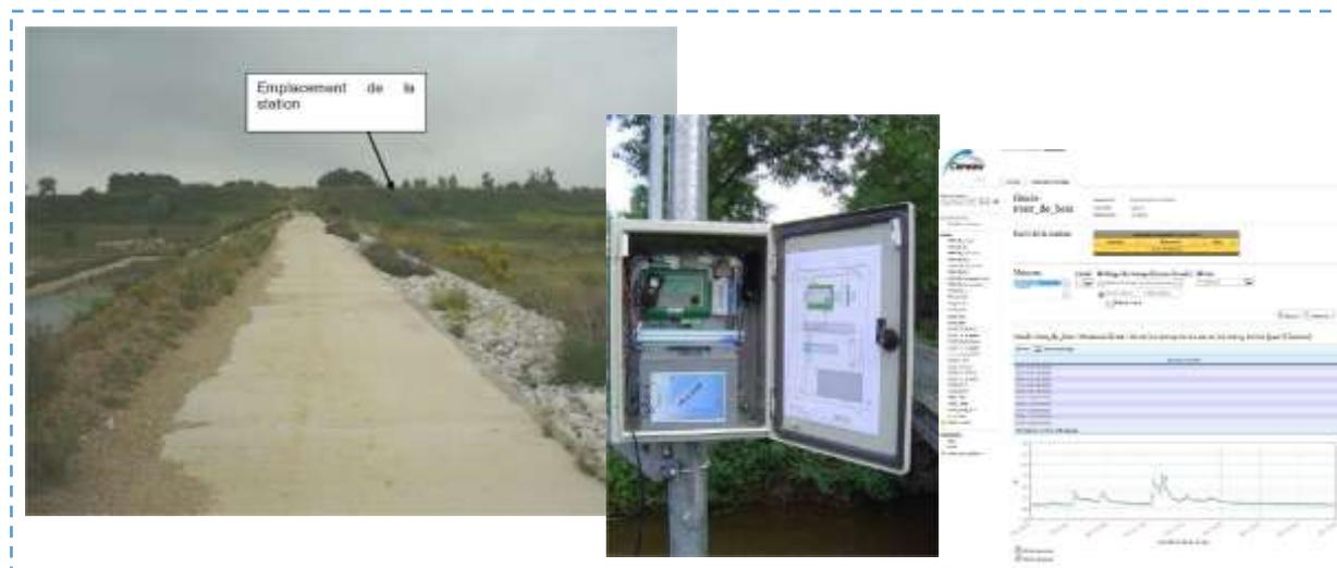
Figure 22 : dispositifs de surveillance des barrages de la Courragade
