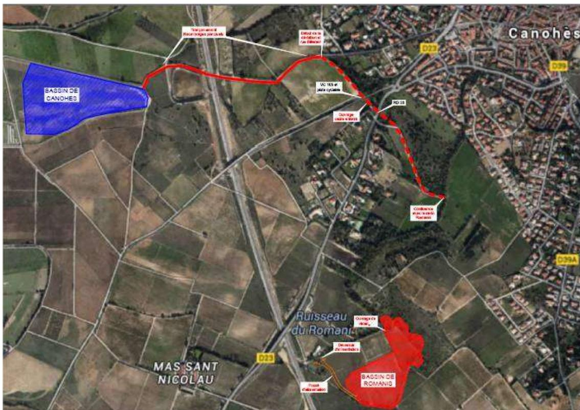
Figure 23 : plan des ouvrages de mise hors d'eau du village de CANOHES par l'agouille d'en Jassal et le ravin des Roumanis
