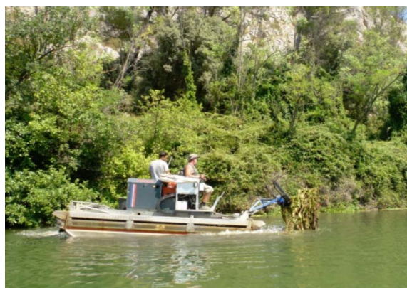
Figure 56 : enlèvement des jussies avec une griffe depuis un engin amphibie
