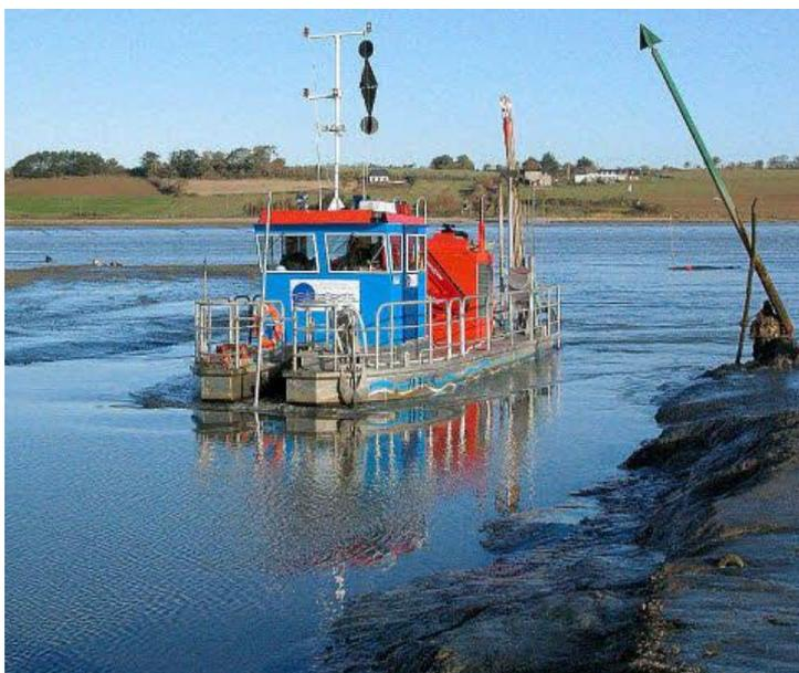
Figure 18 - Exemple d'un curage hydraulique par drague aspiratrice dans l'estuaire de la Vilaine (370 000m<sup>3</sup> IAV)
