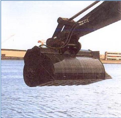
Figure 113 : Godet à clapet pour éviter la dispersion des sédiments à la remontée.
